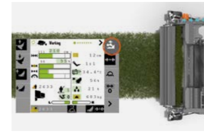
La alimentación hidráulica del PFS se deja ajustar cómodamente desde el asiento del tractor.
