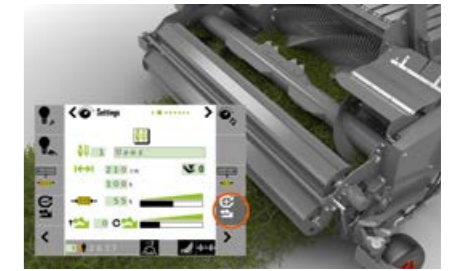
El POWER FEEDING SYSTEM también se puede invertir fácilmente desde la cabina del operario.
