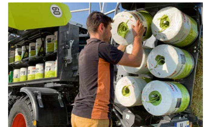
Opcional: Espacio para 12 carretes de hilo adicionales. Esto es suficiente, dependiendo del tamaño del carrete, para 350-400 pacas empacadas.
